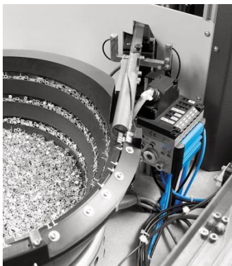
Abbildung 4.1: Vibrationswendelförderer für die Speicherung und Sortierung von Schrauben
